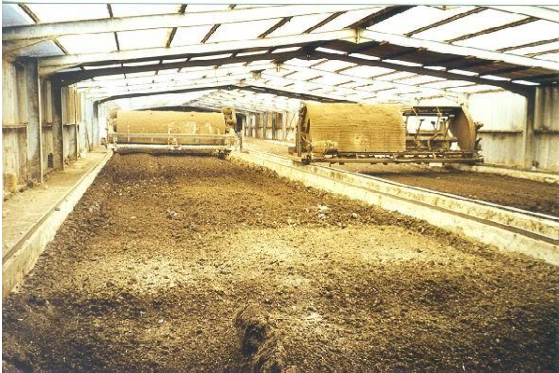
Σχήμα 5. Εικόνα μηχανικά αναστρεφόμενων κομποστοσωρών στερεών αποβλήτων πτηνοτροφείου αυγοπαραγωγής (πηγή: Εργαστήριο Γεωργικών Κατασκευών του ΓΠΑ).
